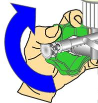
Ouvrir le robinet d'injection et régler le débit pour avoir une diffusion lente du  $\text{SO}_2$
